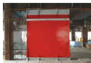
粘性体制振壁
